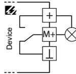
Low-Aktiv: Im aktiven Modus wird das Potential GND auf den Ausgang M+ geschaltet.
