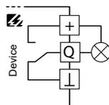
**Low-Aktiv:** Im aktiven Modus wird das Potential GND auf den Ausgang Q geschaltet.
