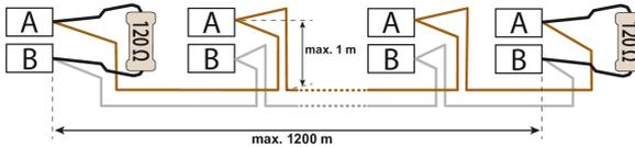
Als Busleitung ist eine paarweise verdrehte, geschirmte Leitung einzusetzen. Geeignet ist beispielsweise der Leitungstyp J-Y(St)Y n x 2 x 0,8 mm<sup>2</sup>. Der Schirm ist einseitig mit PE zu verbinden.
