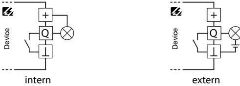
**Permanent High:** Ausgang ist dauerhaft auf +24 V geschaltet.
